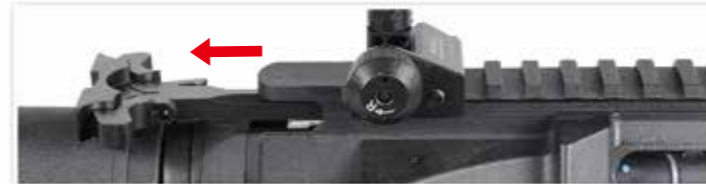
Halando la manija de carga llevará el cerrojo atrás y abrirá la cubierta.
