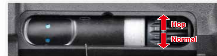
Tournez la molette de réglage pour ajuster le hop-up.
